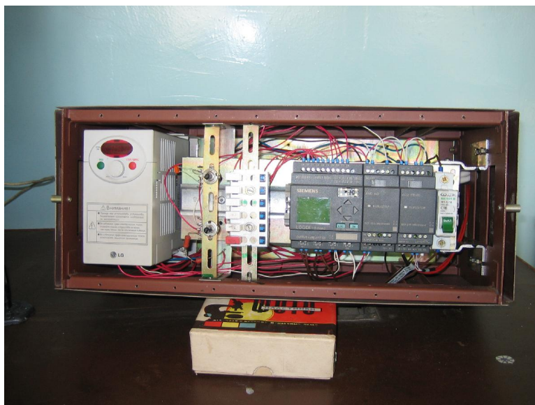
Рис. 3. Блоки управления СЦФ-4: преобразователь частот (справа) и промышленный логический контроллер «LOGO!»
