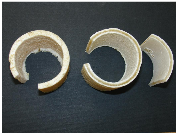
Рис. 6. Внутренняя структура модельного состава «ЭД-20 + 20 % масс. ч. Ф-4», полученного при 40 °С и частотах вращения 300, 1 200, 2 400 мин -1 (слева направо)
