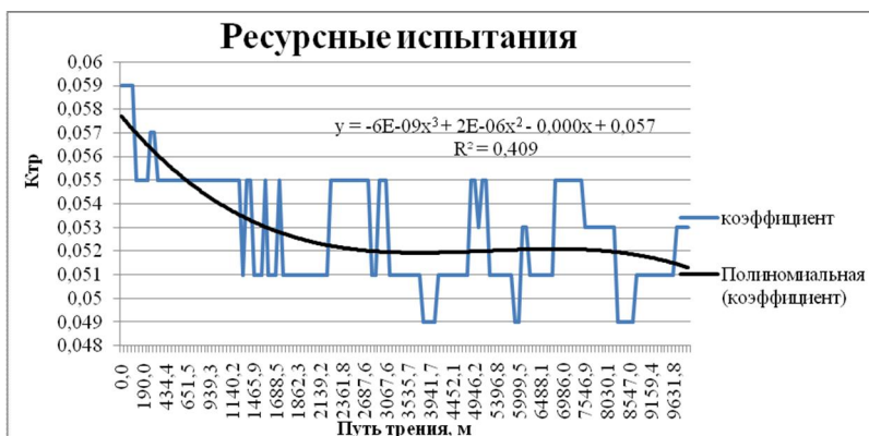
Рис. 8. Результаты ресурсных испытаний материала
