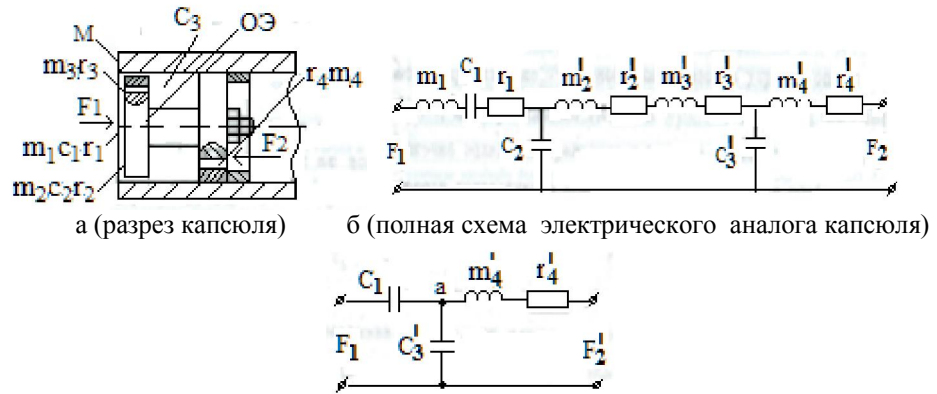
Рис. 2. Конструкция и эквивалентные схемы (а, б, в) электрических аналогов капсюля конденсаторного микрофона
