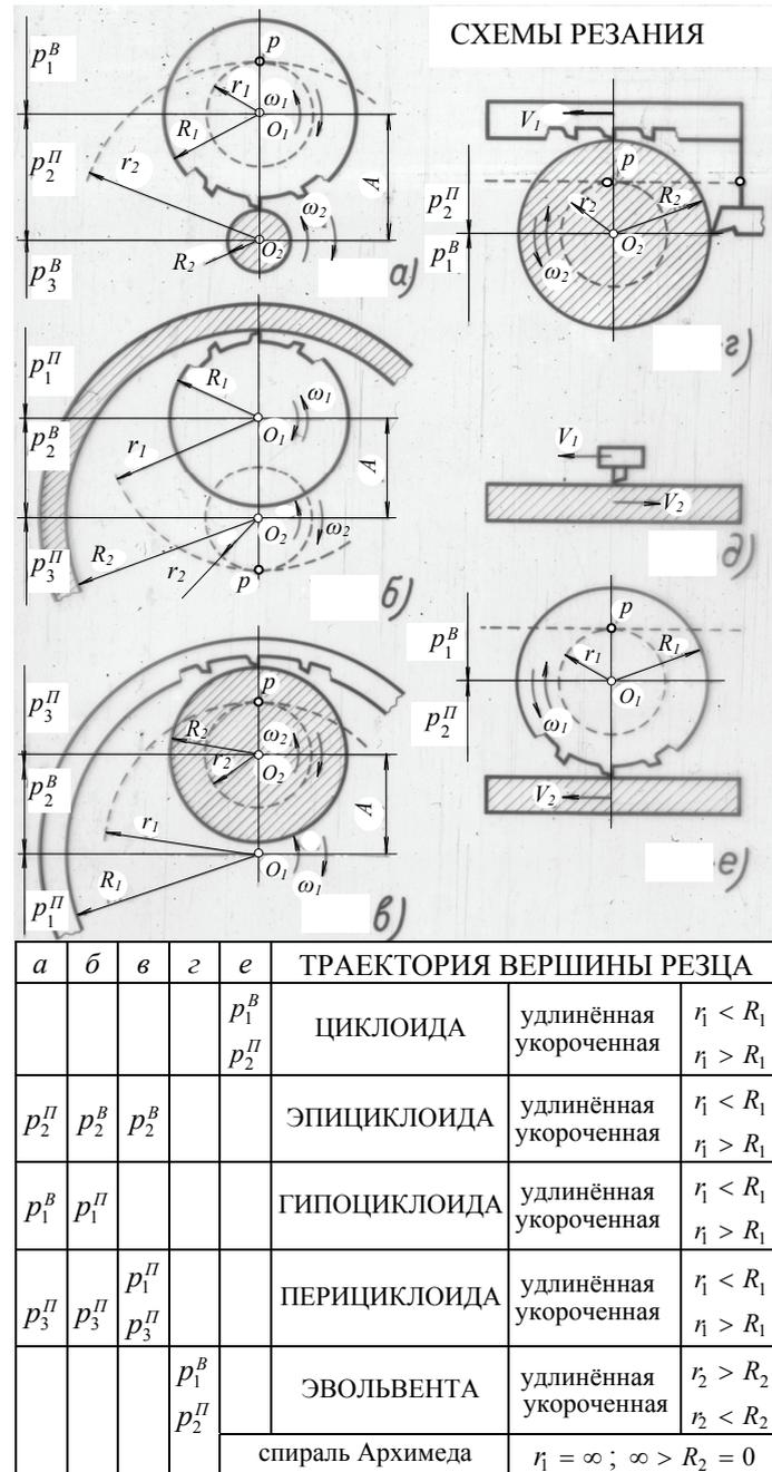
Рис. 1. Схемы тангенциальной обработки
