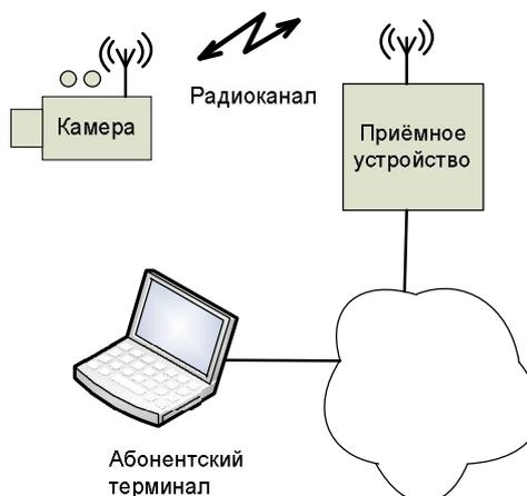
Рис. 1. Система беспроводной передачи видеоизображений
