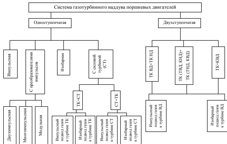
Рис. 1. Иерархическая схема различных систем газотурбинного наддува поршневых двигателей: ТК – турбокомпрессор; ТВД – турбина высокого давления; ВД – высокое давление; ТНД – турбина низкого давления; НД – низкое давление; КВД – компрессор высокого давления; КНД – компрессор низкого давления
