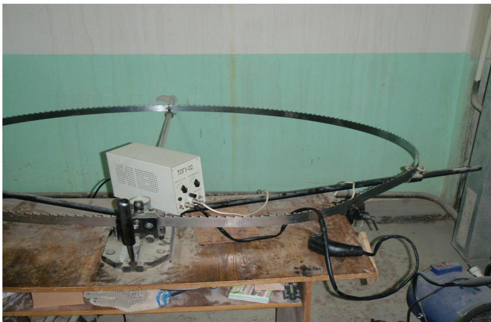
Рис. 4. Общий вид оснастки для разводки зубьев и их упрочнения
